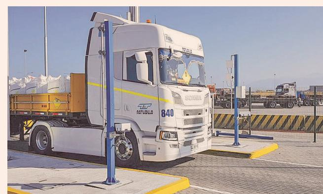
Trazabilidad y captura automática mediante antenas. Control de producción, almacenaje, despacho y recepción cliente/puerto (exportación). En la imagen: control en el despacho.
